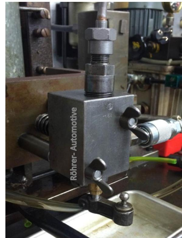
Einspritzpumpe am Prüfstand
