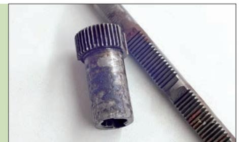
Lange Standzeiten führen an Regelstange und Regelhülse zu den hier sichtbaren Schäden. Die sind für jeden zu erkennen
