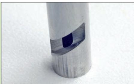
Schäden bleiben dem Laien oft verborgen. Die einsetzenden Riefen am Kolben sind mit „Schrauberfingern“ meist nicht fühlbar
