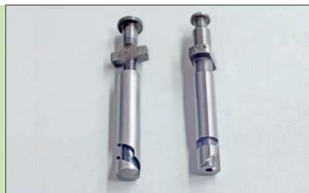
Beide Kolben sehen eigentlich noch gut aus – der eine glänzt halt. Und das ist es eben: Der matte Kolben hat bereits deutlich Verschleiß
