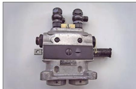
Von einem Güldner: Diese Bosch-Pumpe (PF2B70BS790) arbeitet normalerweise in einem AF 30 mit 2F-Motor aus dem Jahr 1950
