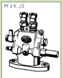
PFR.. K .. für Einsteckbefestigung bei Ein- oder Mehrzylindermotoren (1 Einspritzpumpe je Zylinder) mit Grauguss-Gehäuse
