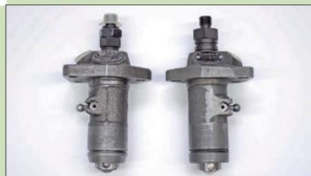
PFR-K-Einspritzpumpen für Einzylinder-Schlepper fördern den Kraftstoff im Eicher G13 und Fahr D 66 – um nur zwei zu nennen
